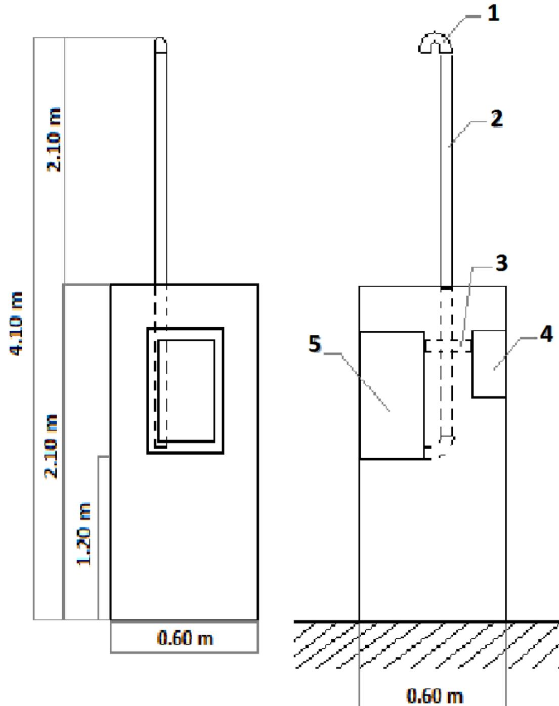
**Nota:** El tablero de protección del Usuario deberá contar con una termomagnetica Tetrapolar y un Diyuntor.
