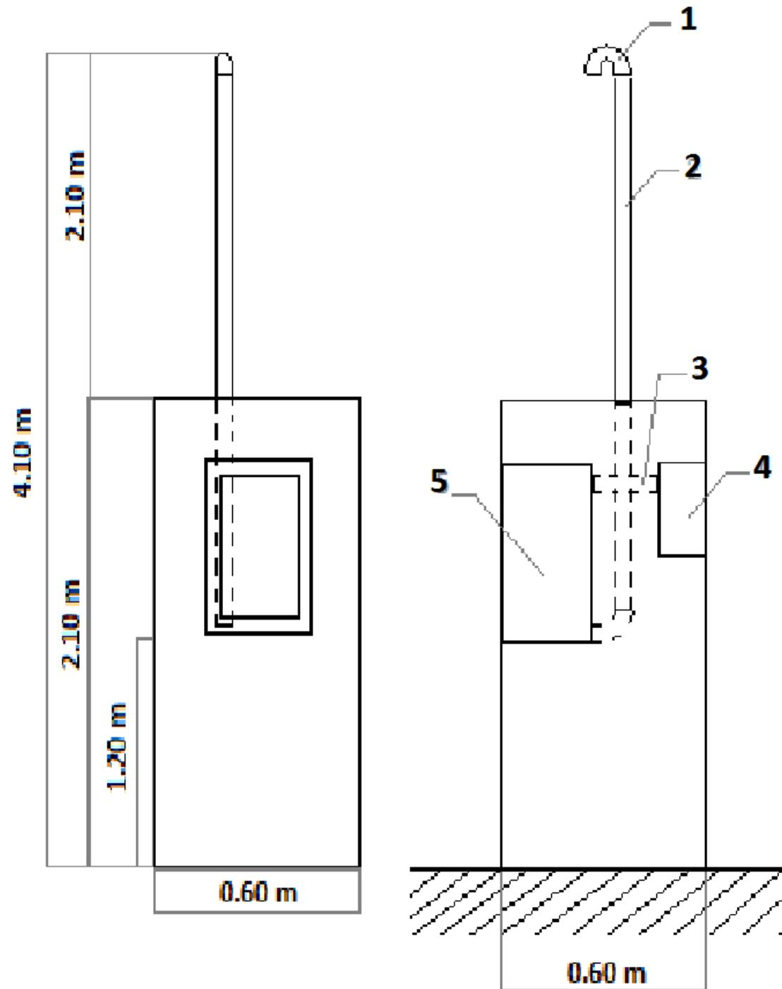
**Nota:** El tablero de protección del Usuario deberá contar con una termomagnética Bipolar y un Diyuntor.
